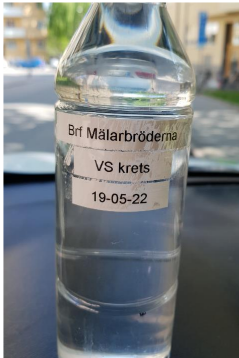
Figur 13. Systemvätskeprov fritt från mikrobubblor.
