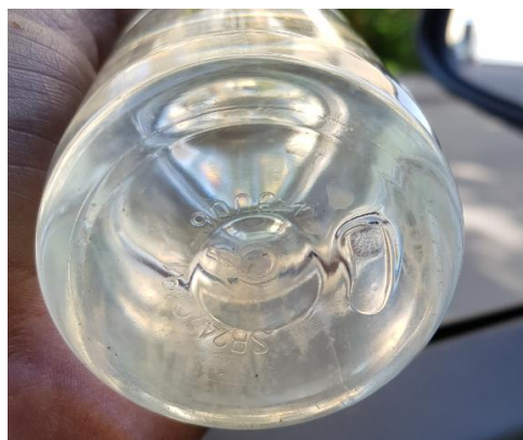
Figur 14. Systemvätskeprov fritt från magnetit.
